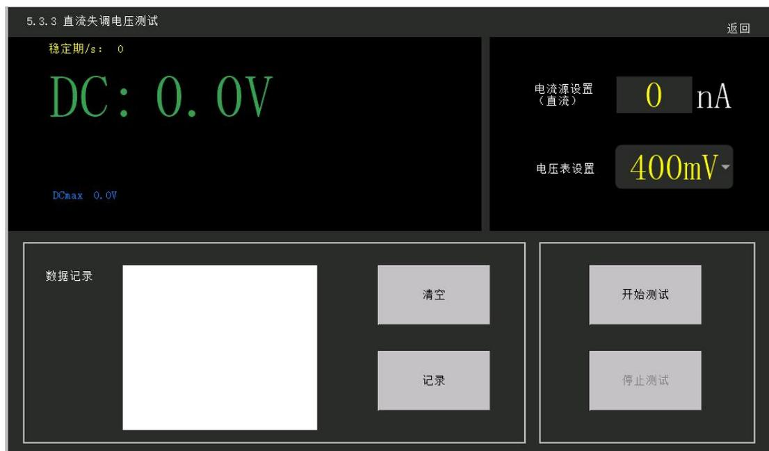
图 5.3 直流失调电压测试页面
